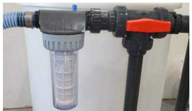
Heavy duty filter en 3-weg klep
