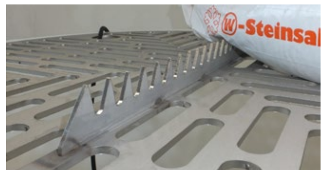
Scherpe rand om zakken te snijden
