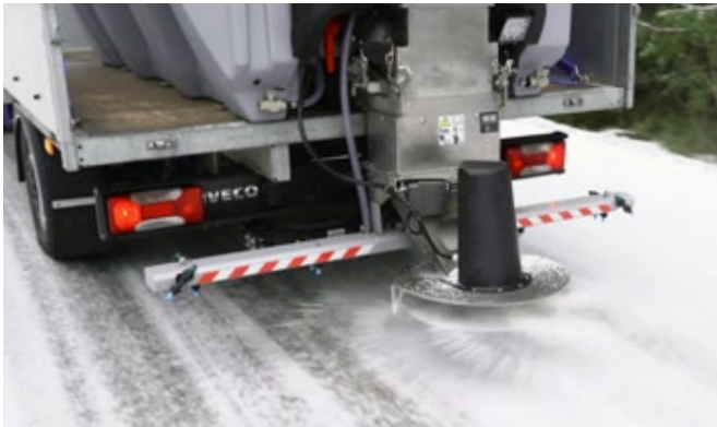
2 m brede sproeibalk (optioneel)
